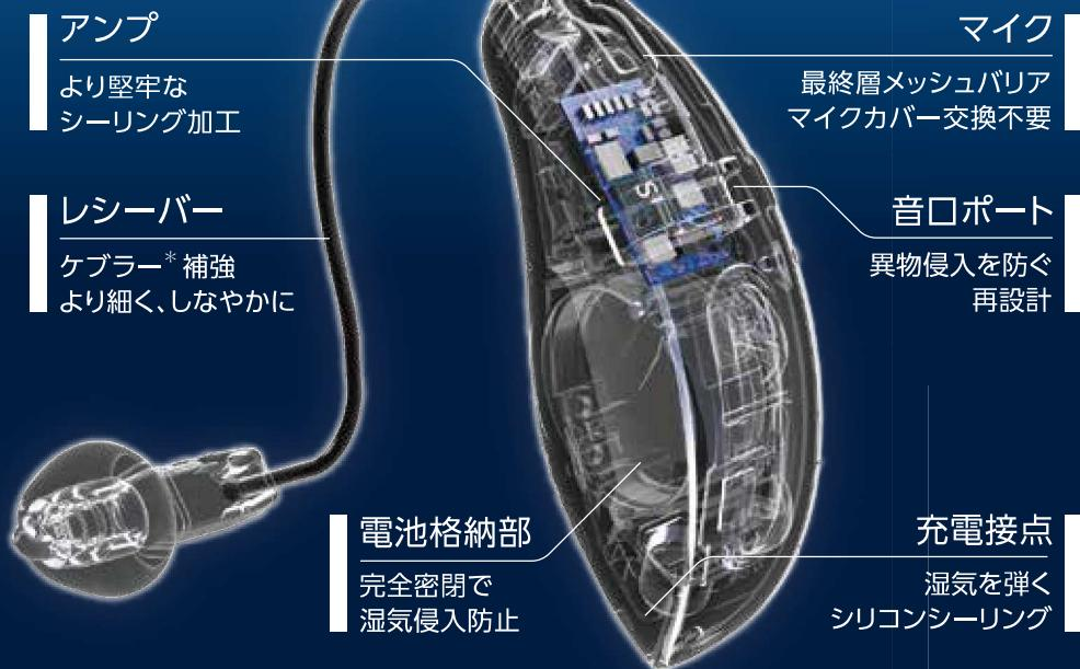
各パーツ：IP68基準を超えた試験をクリアした内外コーティング
