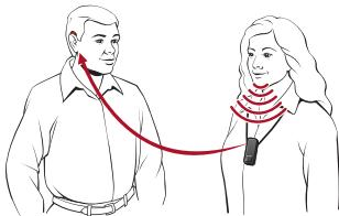
ミニマイクを使用すると、背景雑音のある環境でも話者の声に集中できます。会議用の無指向性マイクとしては最適化されていますが、ミニマイクはテレビ鑑賞などに使用できます。ミニマイクをテレビのスピーカーの近くに置きます。快適な聞き取りを実現するには、テレビのスピーカーとミニマイクの距離を調整するか、ストリーミングの音量を調節します。
