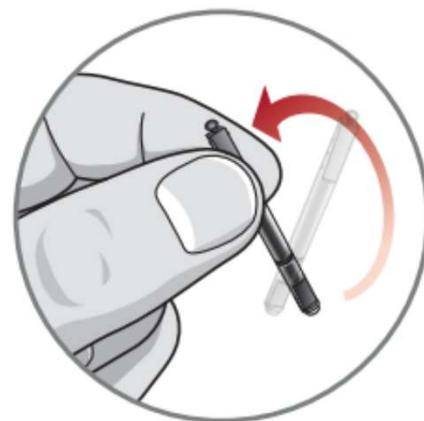
① 新しい棒を取り出し、棒の取り外し側を補聴器のレーザー孔に軽く押しこみます。
