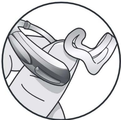
① イヤモールドの付け根側のチューブを持ちます。
