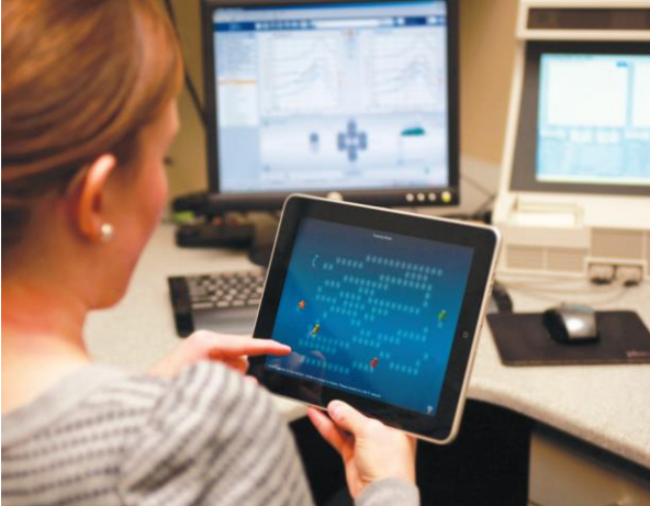
図1. 補聴器ユーザー自身が、iPadによるリモート操作で補聴器を好みのきこえの設定になる様に微調整しています。
